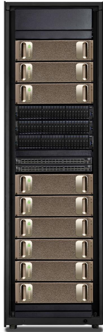
IBM SpectrumAI 与 DGX-1 POD 搭配组合 (9:3 配置)
